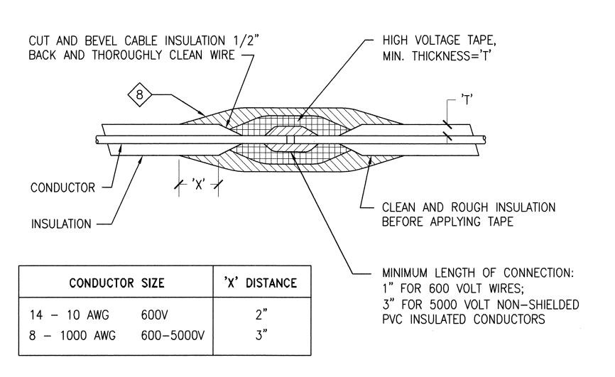
TYPICAL 'TWO-WAY' SPLICE OF 600-VOLT AND 5000-VOLT THERMOPLASTIC WIRE AND CABLE
